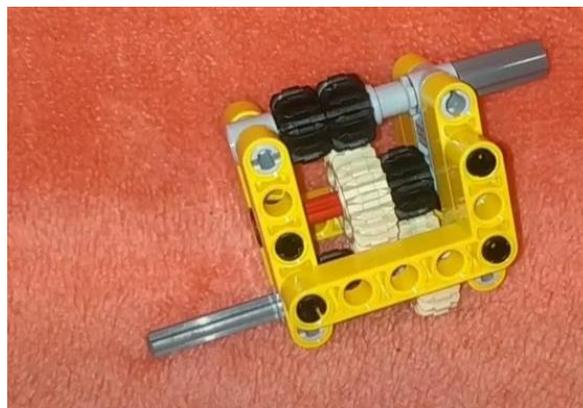
Рис.1. Модель двухступенчатой механической трансмиссии.
