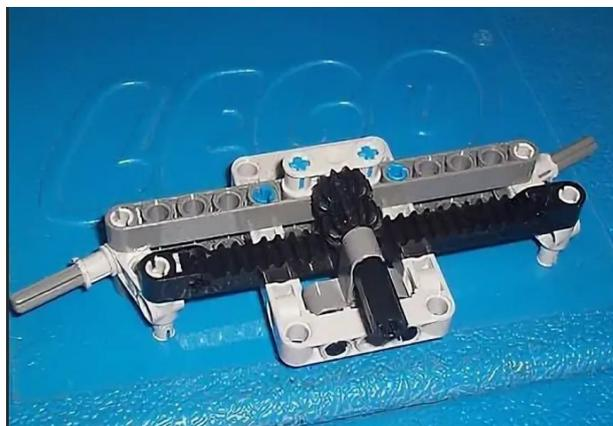
Рис.2. Модель рулевого механизма.
